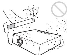
ほこりの多い場所、たばこなどの煙が入る場所での使用は避けてください。この様な場所で使用するとエアーフィルターがつまりやすくなったり、故障や破損の原因となります。また、エアーフィルターの汚れは内部の温度が上昇する原因になるので、ランプ交換に合わせて掃除してください。
