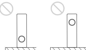
Evite utilizar la unidad en posición vertical apoyada sobre un lateral. Pueden producirse fallos de funcionamiento.
