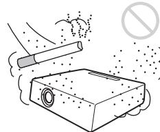
Evite instalar la unidad en un entorno en el que haya un exceso de polvo o humo. Si lo hace, el filtro del aire se obstruirá y es posible que la unidad se averíe o no funcione correctamente. El polvo, que impide que el aire pase por el filtro, puede provocar que la temperatura interna de la unidad aumente. Limpie el filtro de aire siempre que sustituya la lámpara.
