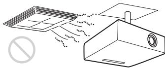
L'installation du projecteur dans un tel emplacement peut causer un dysfonctionnement de l'appareil dû à la condensation d'humidité ou à une augmentation de la température.
