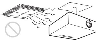
Die Installation des Projektors an einem solchen Ort kann zu einer Funktionsstörung des Gerätes führen, die durch Feuchtigkeitskondensation oder Temperaturanstieg verursacht wird.
