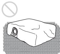
Non usare un tappeto spesso o altro che ostruisca le prese di ventilazione (scarico/aspirazione), per evitare il surriscaldamento interno.
