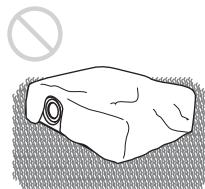
Evite utilizar una alfombra de pelo grueso ni nada que cubra los orificios de ventilación (entrada/salida); de lo contrario, puede producirse un recalentamiento interno.
