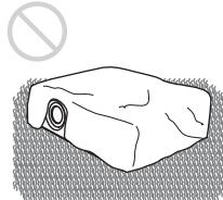
Evitez d'utiliser un tapis à grosses peluches ou tout autre objet pouvant couvrir les orifices de ventilation (sortie d'air/entrée d'air) car cela pourrait entraîner une surchauffe interne.
