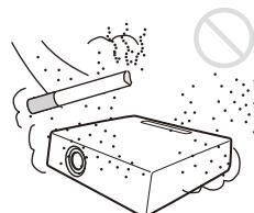
勿将本机安装在多尘或多烟雾的环境中。否则，空气滤网会被堵塞，并可能导致本机故障或损坏。灰尘会阻挡空气透过滤网，从而可能导致投影机内部温度升高。请在每次更换投影灯时清洁空气滤网。
