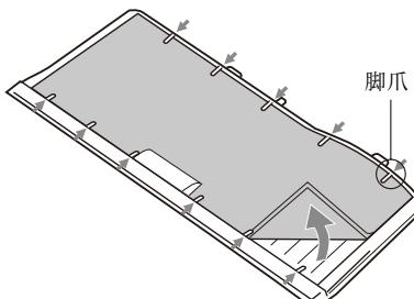
**4** 用中性洗涤剂清洗空气滤网，然后放在阴暗处晾干。
