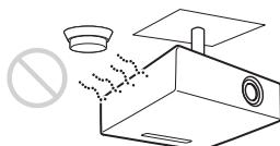
Eine Funktionsstörung des Sensors könnte auftreten.
