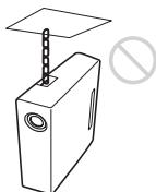
Utilizzare la barra di sicurezza sul retro del proiettore al fine di impedire il furto, ad esempio attaccando un cavo antifurto reperibile in commercio. Se si solleva il proiettore dalla barra di sicurezza, o si sospende il proiettore usando questa barra, il proiettore potrebbe cadere o danneggiarsi.
