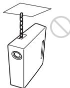
Utilice la barra de seguridad en la parte trasera del proyector para evitar el robo colocando, por ejemplo, un cable de antirrobo de venta comercial. Si levanta el proyector sujetándolo por la barra de
