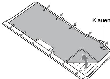
**4** Waschen Sie den Luftfilter mit einer milden Reinigungslösung und lassen Sie ihn an einem schattigen Ort trocknen.
