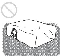
Vermeiden Sie die Verwendung eines Teppichs mit dickem Flor oder irgendetwas, das die Lüftungsöffnungen (Auslass/ Einlass) blockiert, weil es sonst zu einem internen Wärmestau kommen kann.
