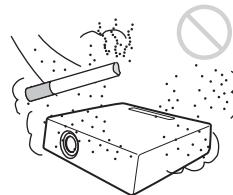
Non installare l'unità in un ambiente molto polveroso o estremamente fumoso. Ciò potrebbe intasare il filtro dell'aria, causando un malfunzionamento o guasto dell'unità. La polvere che impedisce il passaggio dell'aria attraverso il filtro potrebbe causare un aumento della temperatura interna dell'unità. Pulire il filtro dell'aria ogni volta che si sostituisce la lampada.
