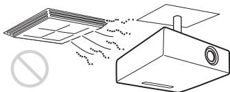
Si se instala el proyector en una ubicación de estas características, la unidad puede averiarse debido a la condensación de humedad o a un aumento de temperatura.
