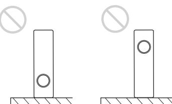
Evitez d'utiliser l'appareil en le plaçant à la verticale sur le côté. Car cela pourrait provoquer un dysfonctionnement.
