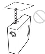
Benutzen Sie den Sicherheitsstift an der Rückseite des Projektors zum Diebstahlschutz, indem Sie beispielsweise ein handelsübliches Diebstahlschutzkabel daran befestigen. Wenn Sie den Projektor an dem Sicherheitsstift hochheben oder ihn an diesem Stift aufhängen, kann dies zum Herunterfallen des Projektors oder zu Beschädigungen führen.
