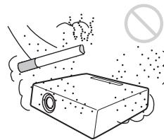
Evitez d'installer pas l'appareil dans un environnement très poussiéreux ou extrêmement enfumé. Le filtre à air pourrait s'obstruer avec, pour résultat, un dysfonctionnement ou des dommages à l'appareil. La poussière empêchant le passage de l'air à travers le filtre risque d'entraîner une surchauffe interne de l'appareil. Nettoyez le filtre à air chaque fois que vous changez la lampe.
