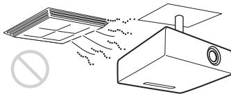
L'installazione del proiettore in una posizione di questo genere potrebbe provocare malfunzionamenti dell'unità dovuti a condensazione dell'umidità o all'aumento della temperatura.
